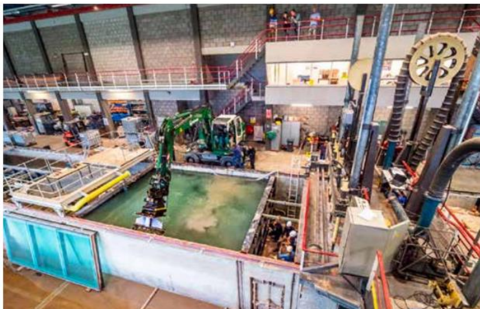
In een op schaal nagebootst Twentekanaal in de water-grondgoot van Deltares kon het aanbrengen- en de werking van het ZBM uitvoerig getest worden.
